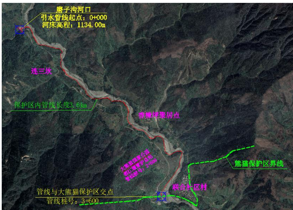
图 4-3 河口取水沿河输水方案布置图
